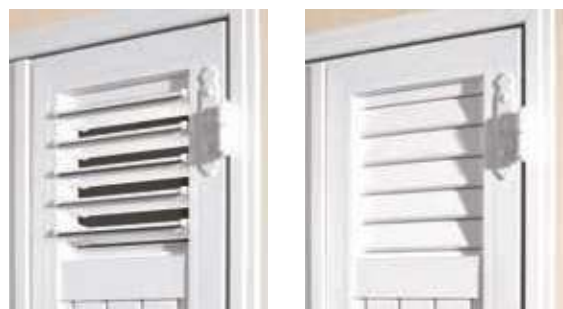
Volet ajouré avec lames extrudées de 47 x 10. Cadre volet de 80 x 33 avec moulure.
